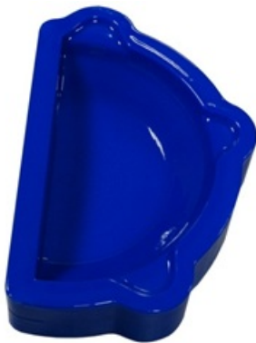
Figura 6 - Molde para laminação fabricado por manufatura aditiva
