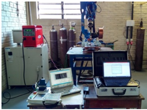
Figura 1. Sistema experimental utilizado para as deposições e aquisição de dados
