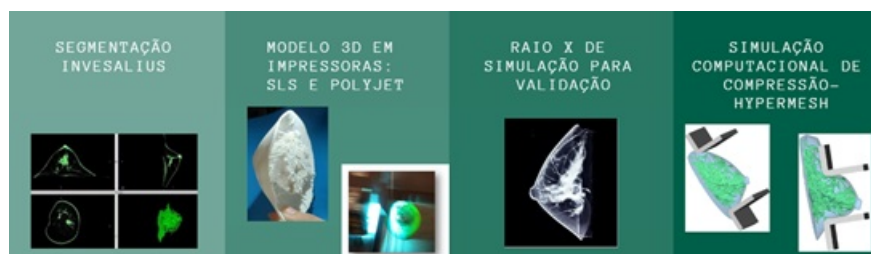
Figura 5. Modelos realizados de simulador radiográfico da região da mama. Fonte: autores.
