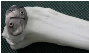
Figura 3. Guia de corte em metal para osteotomia confeccionado em impressão 3D. Fonte: Universidade de Araraquara - Uniara.
