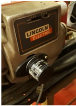
Figura 4. Mecanismo físico acoplado para medida de velocidade de alimentação
