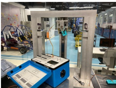
Figura 8: Corpo de prova fixado na máquina de tração
