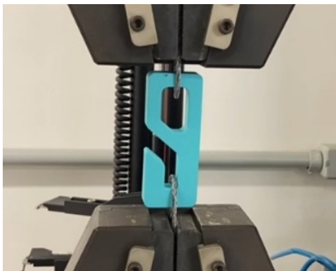
Figura 7: Corpo de prova fixado na máquina de tração
