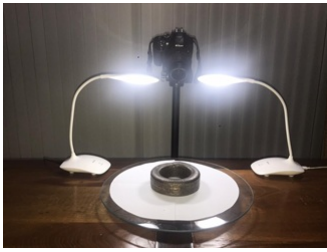
Figura 2: Vista frontal da bancada para o registro das fotografias utilizadas na confecção do modelo 3D a partir do processo de Fotogrametria.
