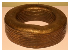
Figura 1: Peça fabricada pelo processo de Manufatura Aditiva por Deposição a Arco.
