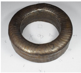
Figura 4: Caracteres aleatórios dispostos no plano da plataforma rotativa, ao redor e no interior do objeto de estudo.
