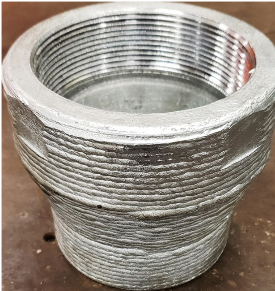
Figura 9 – Aspecto Final da luva concêntrica de redução NPS 4x3
