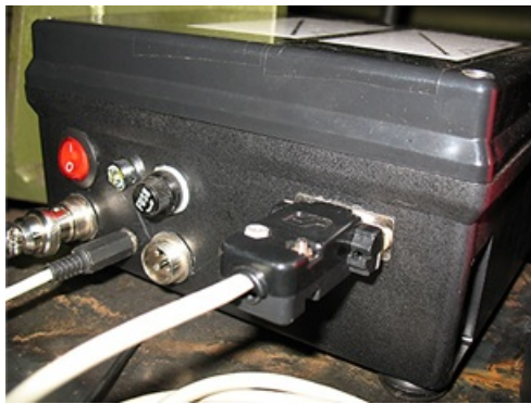
Figura 4 - (a) Interface A/D USB e (b) condicionador de sinais elétricos
