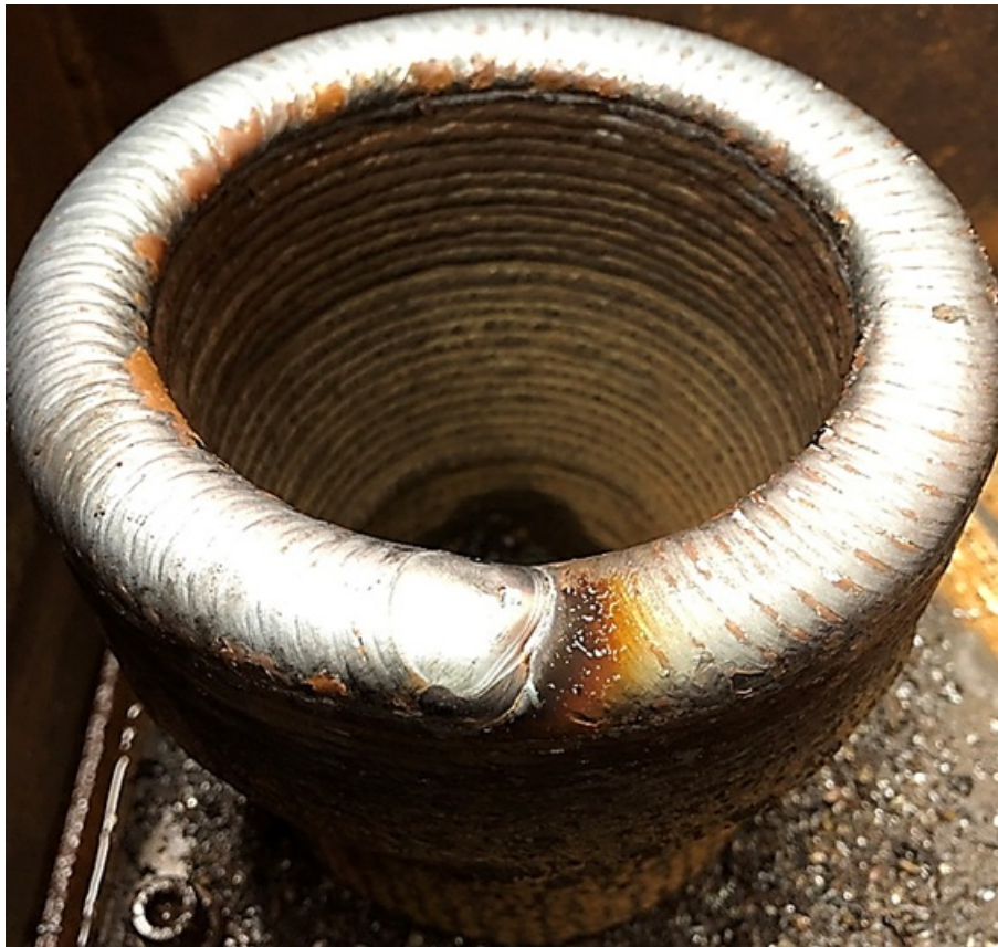
Figura 6 - Pré-forma definitiva da luva concêntrica de redução NPS 4x3
