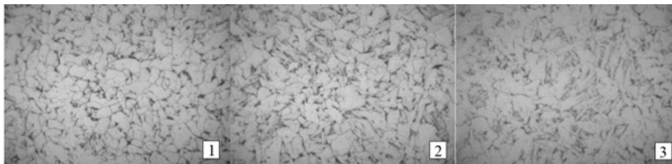
Figura 5 - Microestrutura típica das amostras com ampliação de 500x e ataque de Nital 2%. As três amostras apresentaram uma microestrutura composta por ferrita e perlita fina.
