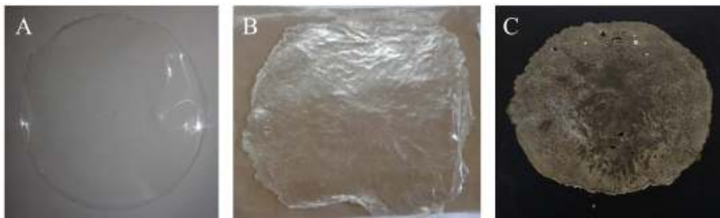
Figura 1. Filmes de amido de fruta-do-lobo elaborados com métodos: A) casting , B) solução filmogênica aquecida em micro-ondas e termoprensada, C) pasta filmogênica produzida em micro-ondas e termoprensada.
