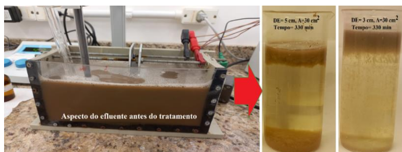
Figura 1. Aspecto do efluente antes e ao final do processo de EC/EF empregado no tratamento do EPLV com DE igual a 3 e 5 cm
